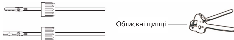
Рисунок: Обтисніть контактний штифт до дроту
