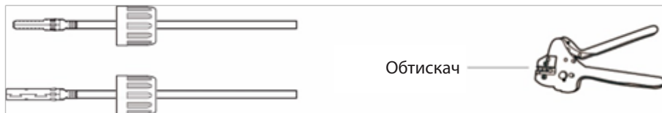
Малюнок 4.10 Обтисніть контактний штифт з дротом
