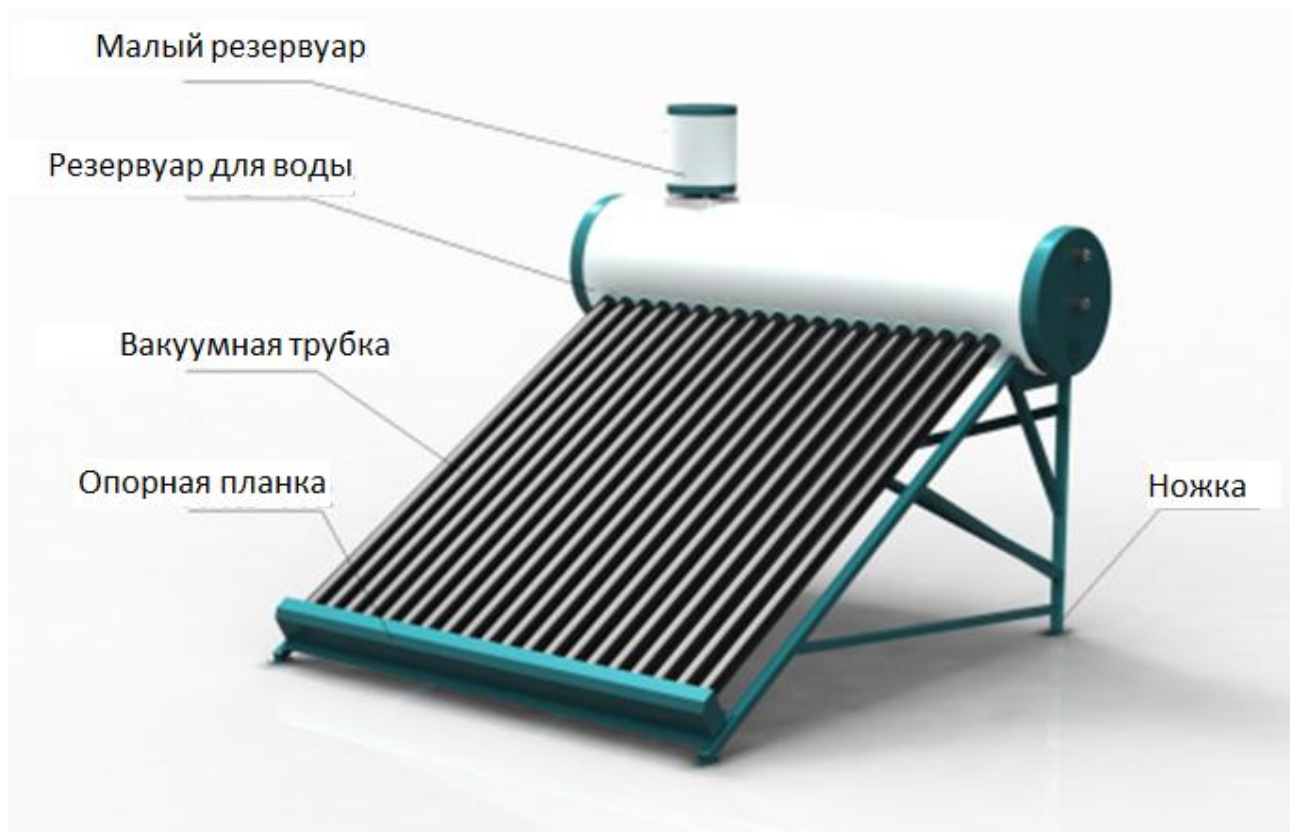
Конструкция солнечного водонагревателя
