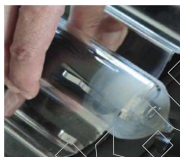
газопоглотитель разрушен, трубка неисправная
