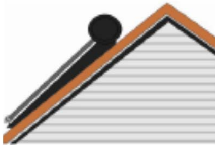
Гелиоприёмник, установленный на наклонной кровле.
