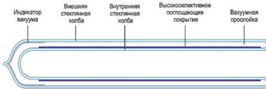
Продольный разрез коаксиальной вакуумной трубки
