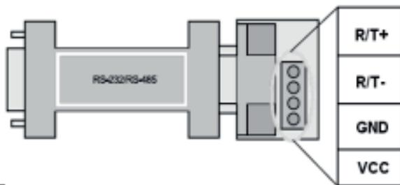
Рисунок 17 – Конвертер AKSG/ RS232
