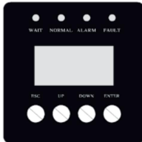
Рисунок 6 – Панель керування із РК-дисплеєм
