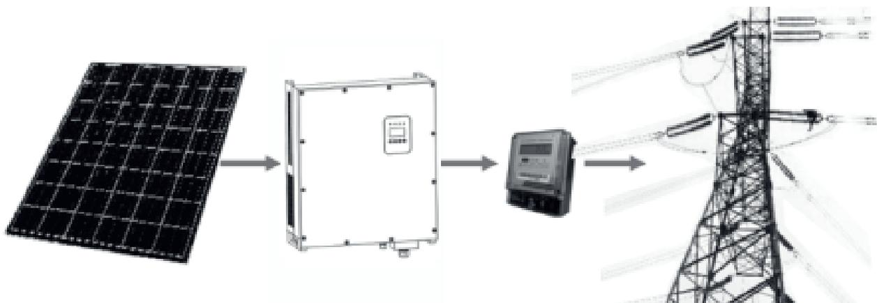
Рисунок 1 – Використання фотоелектричного інвертора, з'єданого з електричною мережею в системі виробництва електроенергії.
