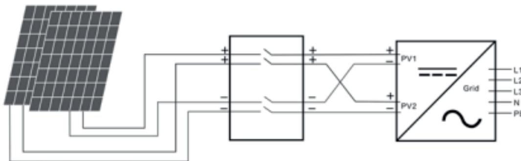
Рисунок 4 – Режим незалежного входу
