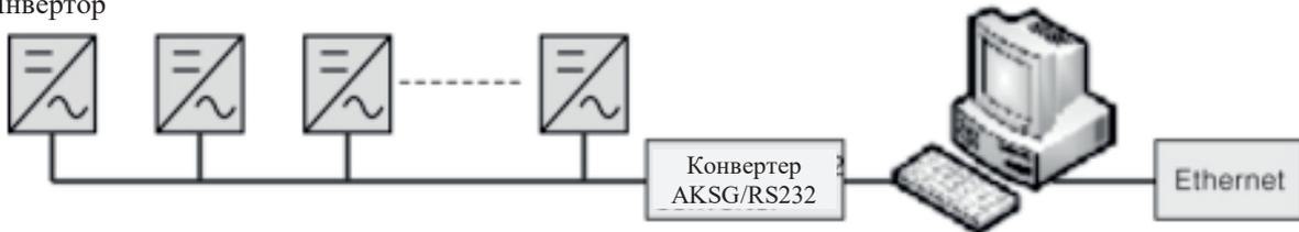
Рисунок 8 – ПК здійснює моніторинг через інтерфейс AKSG
