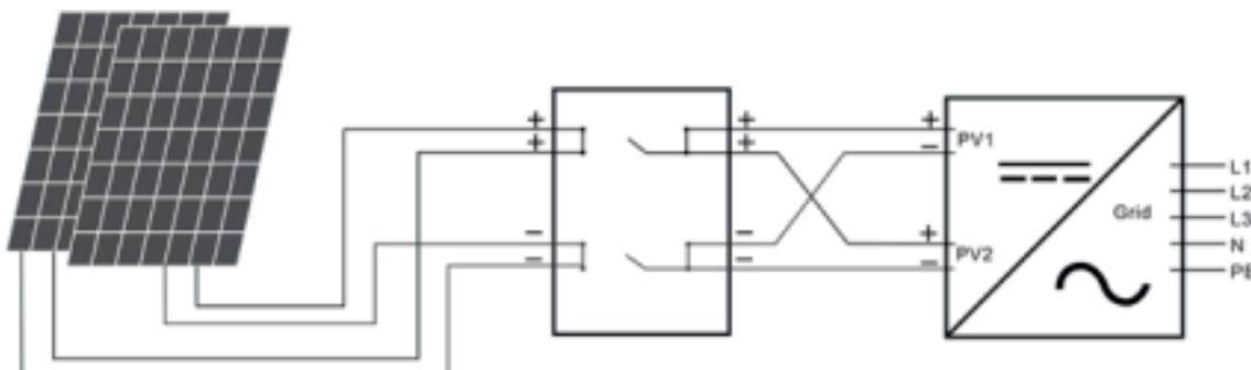
Рисунок 5 – Режим паралельного входу
