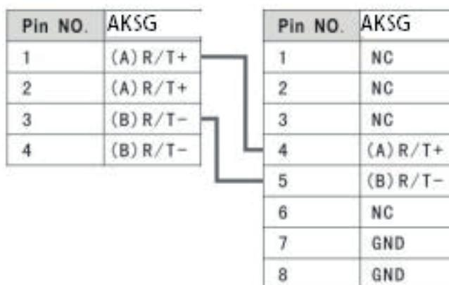
Рисунок 19 – Схема підключення блоку збору даних до інвертора
