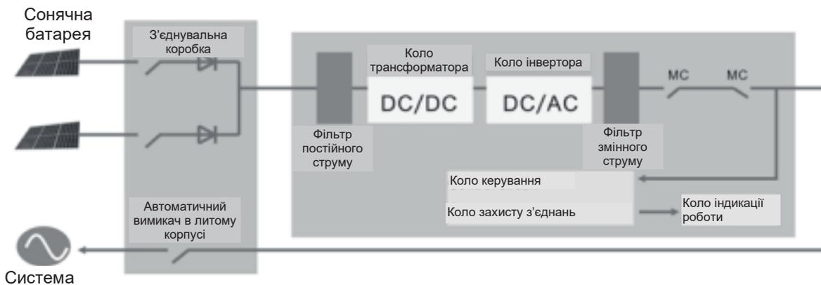
Рисунок 2 – Структурна схема основного кола інверторів ACRUX-10K /12K /15K /17K /20K
