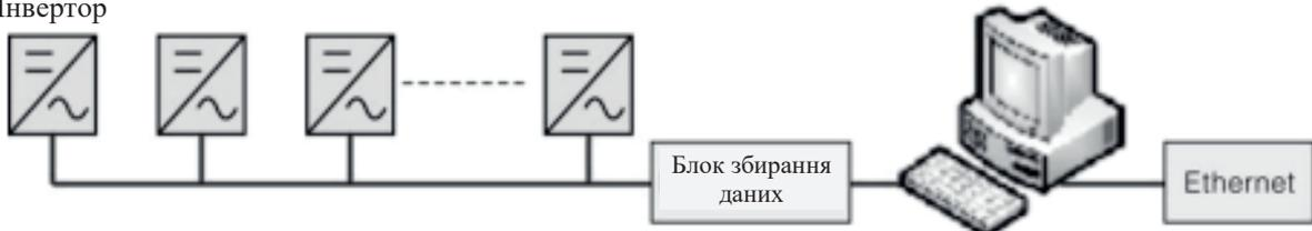
Рисунок 9 – Блок збирання даних і ПК здійснюють моніторинг через інтерфейс AKSG
